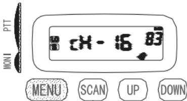
Функция сканирования будет возобновлена через некий промежуток времени после приема сигнала. Этот промежуток может быть установлен от 0,5 до 5 секунд.
